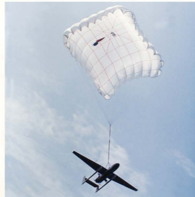
80年代研制的多用途无人机试飞成功。图为伞降回收。
